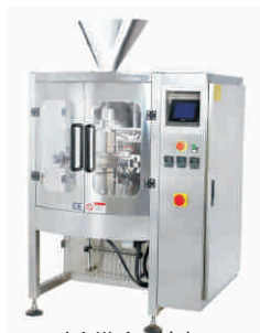
制袋包装机 Bag making machine
